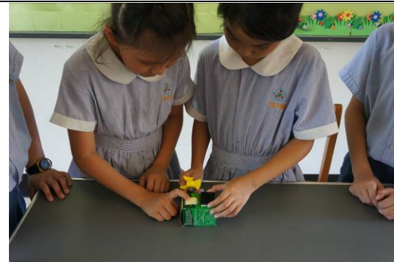
(6)將泡棉膠帶貼在電池的上方
