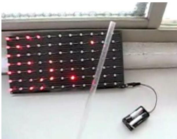
圖 2、負電檢測結果之呈現—LED 燈熄滅
