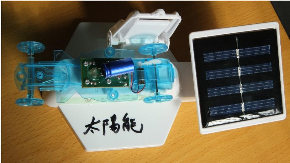
2. 電容就像蓄電電池一樣可以儲存電力，穩定電壓，直到電力用完為止。
