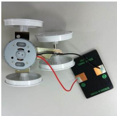
4. 用 9(泡棉)填貼固定 1(馬達)和 10(太陽能電池)即可完成。
