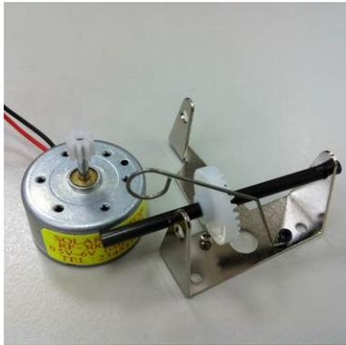
2. (1)前步驟組好的 1 穿過 2，用小型起子將螺絲栓緊；(2)8 穿過 2 之後，裝上 11(兩個車輪)，剩下兩個車輪裝上 3。
