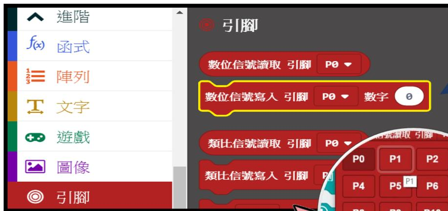
從“引腳”選取“數位訊號寫入 引腳 數字”設定參數 (設定腳位或是其他接點的值，格式為數位訊號0和1) 可用於對“光敏電阻”輸入電壓，數字0和1代表是否寫入電壓。
