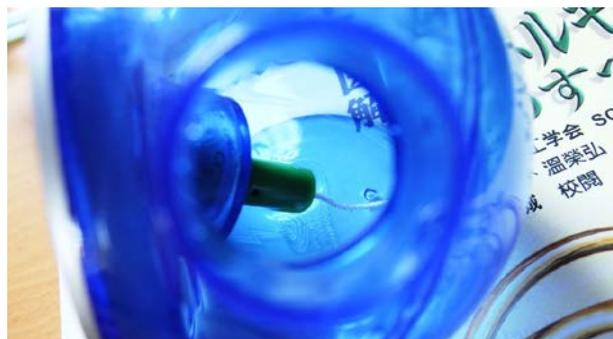
「水時鐘」的原理是利用時鐘內金屬間的不同電位差特性，加水活化產生電流，提供能源。只要有水就可以產生電力，沒電加水即可。也可以用果汁、汽水、可樂、茶…等能導電的水溶液試試看。
