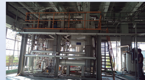
降低委外處理燃料費用 - 透過蒸發設備回收 KI
