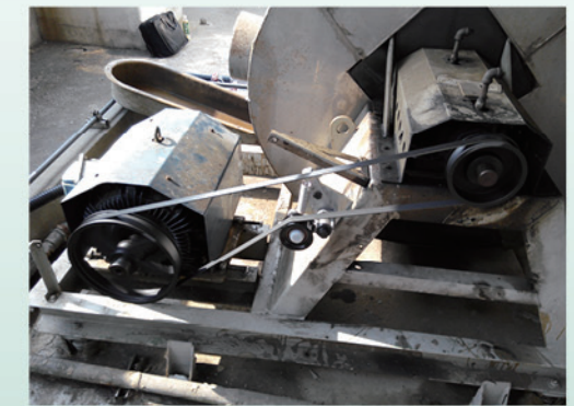
平面皮帶 - 風車皮帶改為平面式
