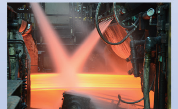
變更除銹水噴嘴流率，進而降低鋼胚出爐溫度
