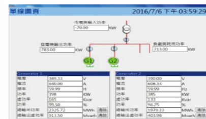
沼氣發電、用電負載、台電功率顯示畫面
