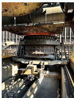
以一階淬火車支援二階接焦增加乾式淬火發電量
