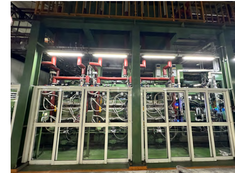
碳纖製程能源轉換 - 電熱成型改為熱煤鍋爐系統
