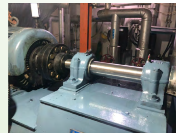
風扇葉輪動平衡校正
